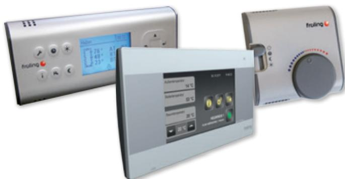
Die **Regelung S-Tronic** steuert das Saugzuggebläse an und bietet die Möglichkeit zum Anschluss einer Pufferspeicher-Ladepumpe und einer Heizungspumpe. Die überwachte Abgas- und Kesseltemperatur sorgt für eine effiziente Verbrennung.
